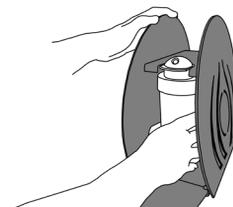
**Poser la recharge sur le fond du diffuseur et la pousser jusqu'à complète insertion.**
