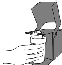
**Poser la recharge sur le fond du diffuseur et la pousser jusqu'à complète insertion.**
